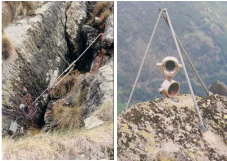
Fig. 9: Exemple d'extensomètre et de réflecteur infrarouge pour les mesures télémétriques (Document CREALP).
