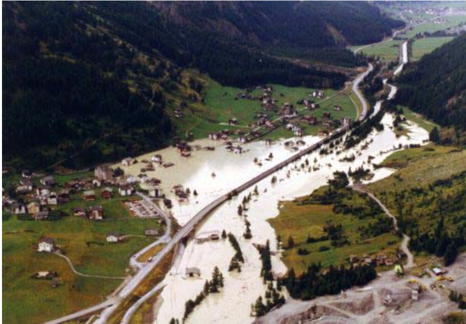
Fig. 15: Exemple d'implication secondaire lors de l'éboulement de Randa l'inondation provoquée par l'obstruction du lit de la Vispa par l'éboulement (Document CREALP).
